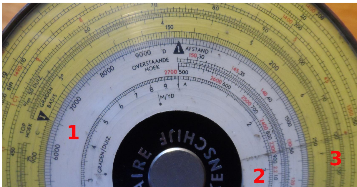
Fig. 3. Instellen afstand en overstaande hoek; aflezen tophoek.
