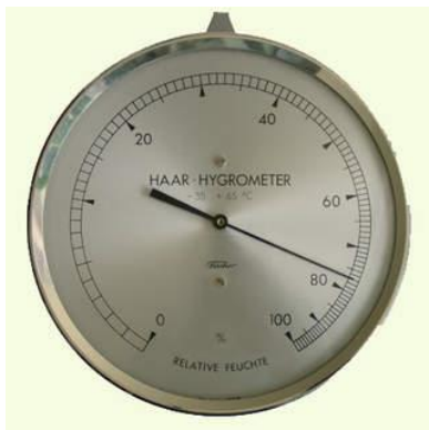
Fig. 1. Een hygrometer met een haar als vochtigheidsdetector.
