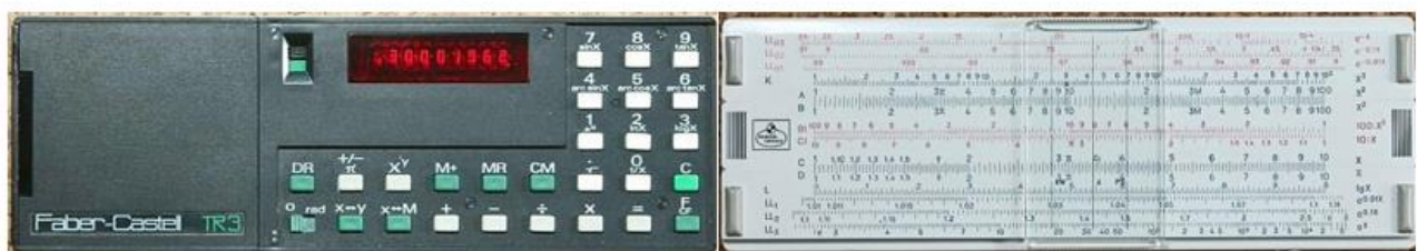
Fig. 1. Voor- en achterkant van het F-C TR3 hybride model
