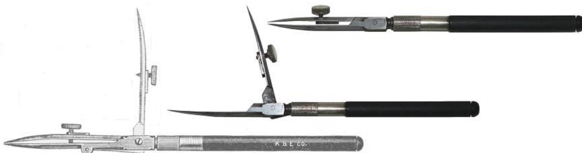
afb. 10a en b – trekpenner met knipmesscharnier; van Richter, gesloten en open; afb. 11 – idem, Keuffel & Esser
