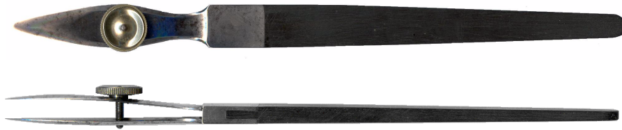
afb. 16 – 'zweedse' trekpen met ebbenhouten greep, onbekend fabrikaat
