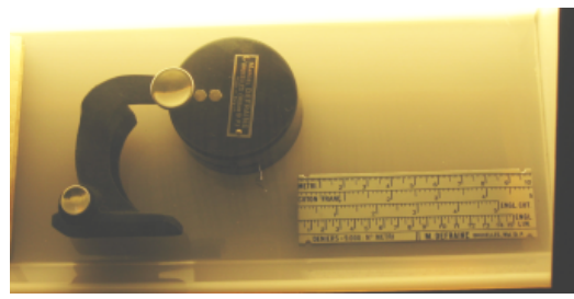
Apparaat om de treksterkte van een draad te meten en met het schaallatje om te rekenen.
