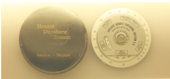
Apparaat om de treksterkte van een draad te meten en met het schaallatje om te rekenen.
